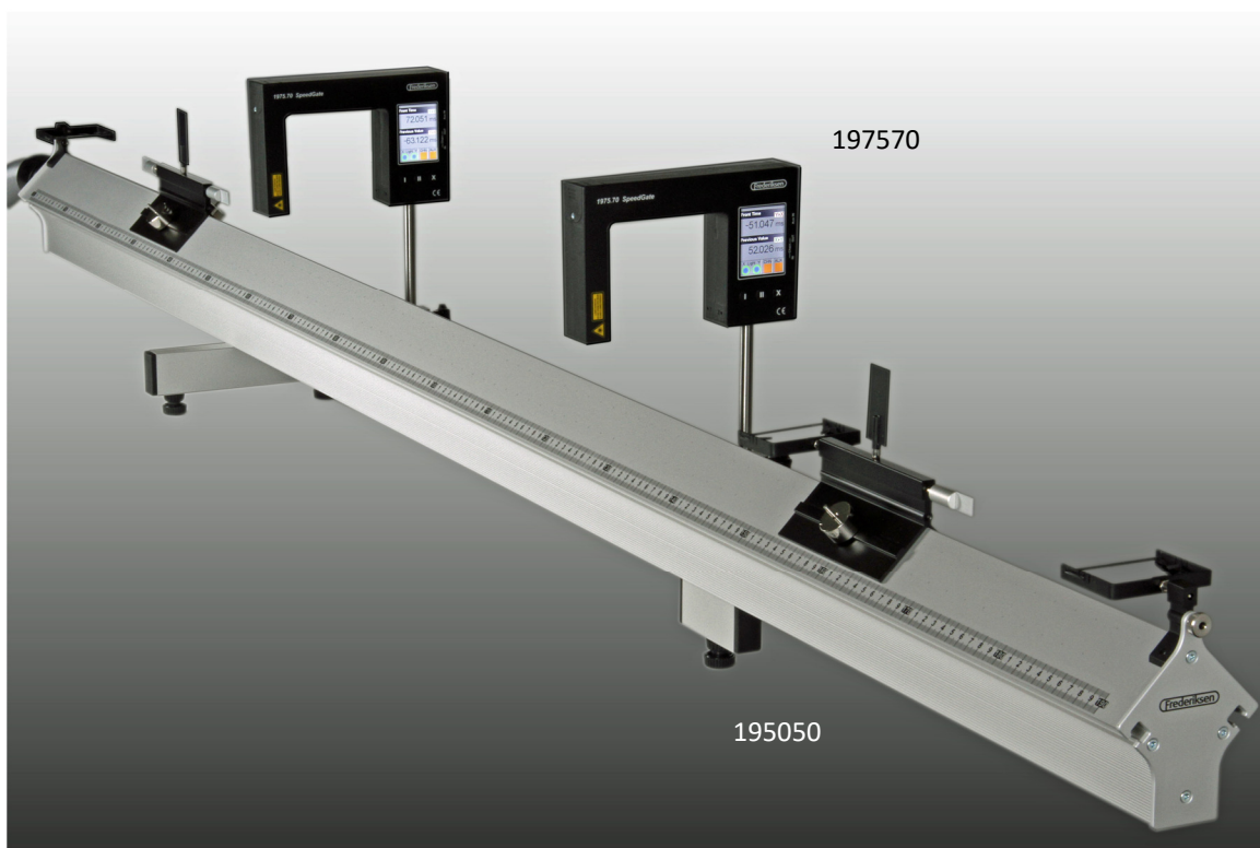
(Billedet viser vores luftpudeskinne 195050. Forsøget udføres ligeså godt på skinne 195000 eller 195010)
